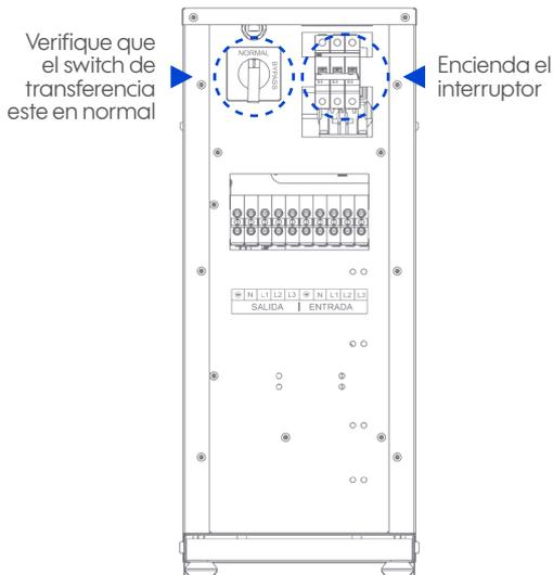
8. Realice mediciones de voltajes en la entrada y la salida del AMCR GEN 3 para comprobar el adecuado funcionamiento del equipo.
