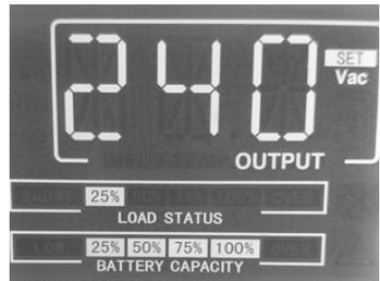
**Figura 2-11** Tensión de salida de 240 V
