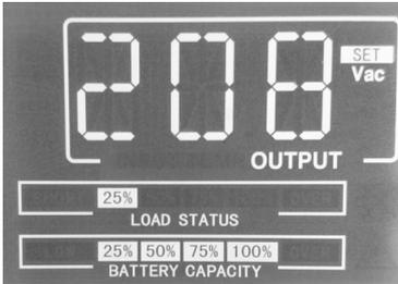
**Figura 2-8** Tensión de salida de 208 V
