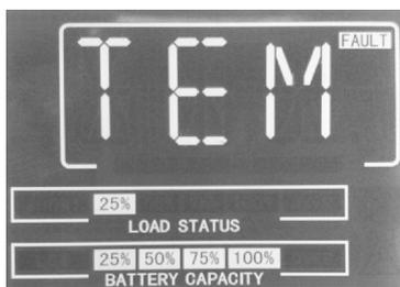
**Figura 2-14** Sobrecalentamiento del IGBT
