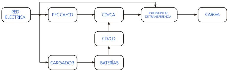
**Figura 2-7** Principios de funcionamiento del UPS de la serie 3 kVA
