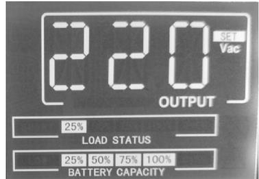
**Figura 2-9** Tensión de salida de 220 V
