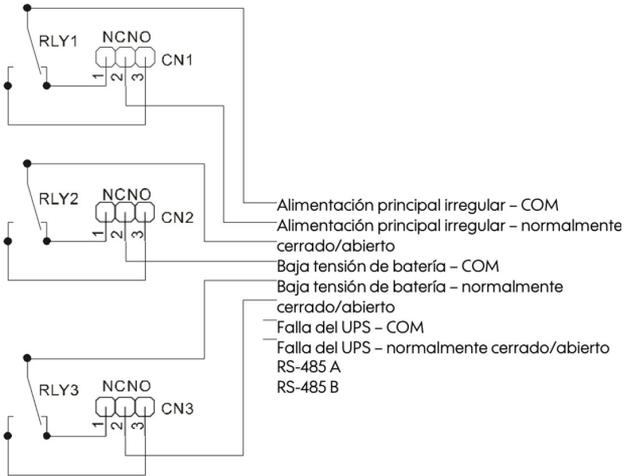
Figura 2-6 Definición de las clavijas del puerto RS-485 y de contacto seco
