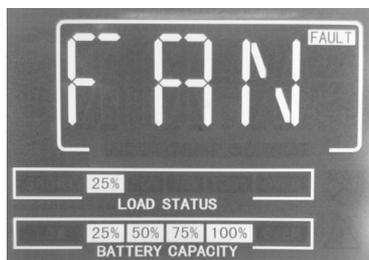
**Figura 2-15** Falla del ventilador
