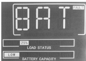
**Figura 2-16** Falla de la batería
