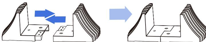
**Paso 3** Fije un soporte conjunto en cada lado del UPS con cuatro tornillos M4 x 10 mm.
