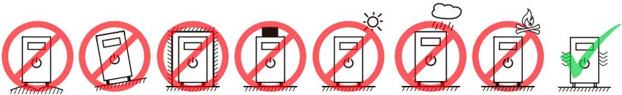
Figura 4-1 Precauciones de instalación y uso del UPS
